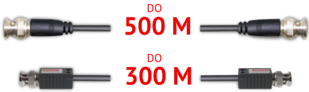
Schemat działania systemu HD-CVI (sygnał wideo, audio i sterowanie 1 przewodem)
